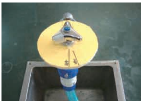
図2. 水道の蛇口部分に取り付けた流量の調節器具.
