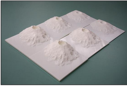
図2. 3Dプリンターで製作した三宅島南西部の火山モデル。
