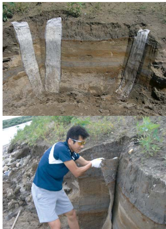
図2. 凝固剤を塗りつけた後、地層をはぎ取る様子
