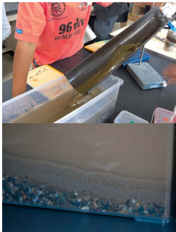
図6. 水槽を使った地層形成のモデル実験.
