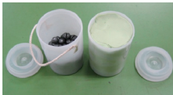
図2. 空気が関係しないことを実証するための実験。一方には鉛の錘、他方には粘土を隙間なく入れて、質量を同じにした。
